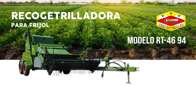
Facilita la recolección de frijol, posteriormente de que éste es trillado, así como su desgrane, la recolección del fríjol es realizada por un cilindro con resortes tipo "Sun", éstos arrojan las vainas hacia el cilindro estrella, donde serán recogidas por la banda transportadora y dirigidas al cilindro de trilla.
