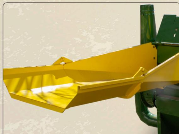
La tolva de recepción y su extensión conducen el forraje hacia la boca de trituración, de ahí al interior de la cámara, dónde se encuentra el cilindro de trituración.
