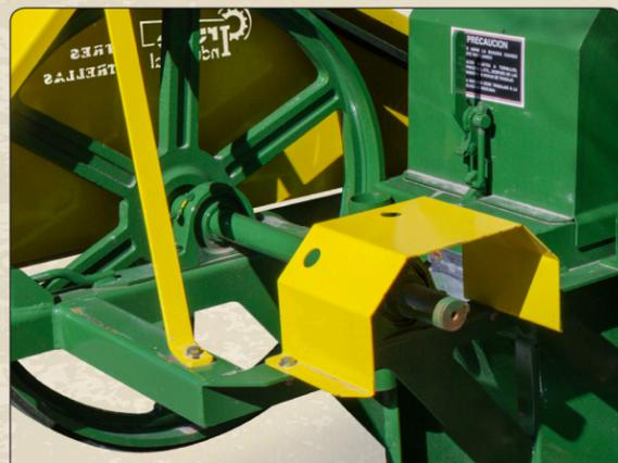
En la imagen observamos el eje motriz, dónde se conecta la toma de fuerza, la polea motriz de fundición, así como las respectivas guardas, para proteger al usuario.
