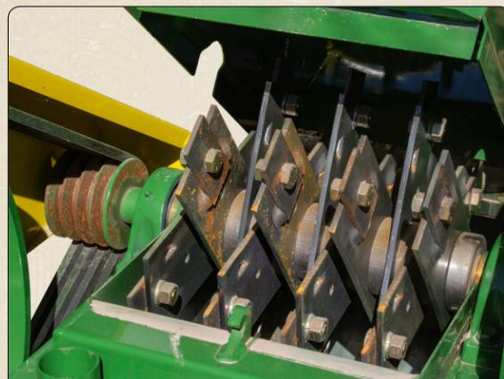
El cilindro de trituración cuenta con martillos fijos, al costado izquierdo se encuentra la polea conducida para cuatro bandas trapecoidales (tipo "V").
