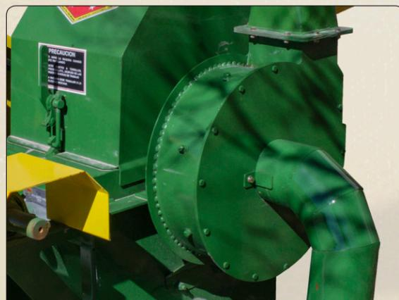
Esa forma circular, es dónde se localiza el abanico extractor, que se encarga de expulsar el producto de la molienda por los tubos hacia la tolva ciclónica.
