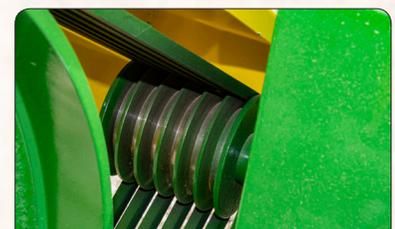
*Polea conducida y las seis bandas trapezoidales.*
