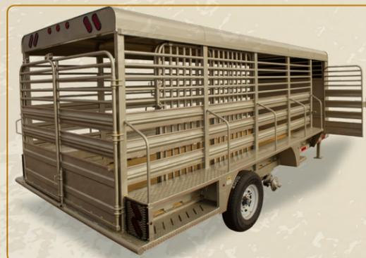
Techumbre metálica que recubre la totalidad de la zona de carga, con un domo de fibra de vidrio en la parte frontal. Tiene una puerta de escape, con duela metálica y travesaños tubulares, en la parte lateral delantera derecha. En esta imagen se observa la puerta replegada en las redila, conformando un solo espacio en toda el área de carga.
