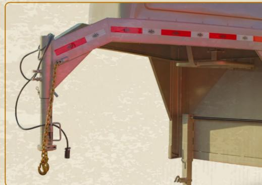
Cuello de ganso con jalón de fierro vaciado, admite bola de remolcado con un diámetro de 2<sup>7/16</sup> pulgadas. El montante es de acero estructural fabricada en viga de 8 pulgadas. Conector eléctrico hembra, de una sola pieza, redondo, de cuchillas, para 6 polos. Estructura para fijar la llanta de refacción, ubicada en la parte inferior del montante.
