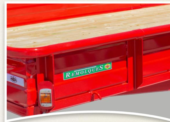
Luces de leds, ganchos para sujeción y atado de las cargas, redilas de 15<sup>1/4</sup> pulgadas, reforzados con postes de ángulo.
