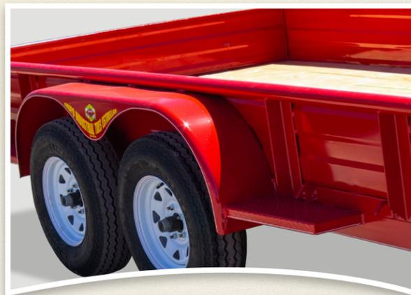
Llantas y rines de 15 pulgadas, estribos en lámina antiderrapante, guardafangos dúplex, tipo gota, piso de madera.
