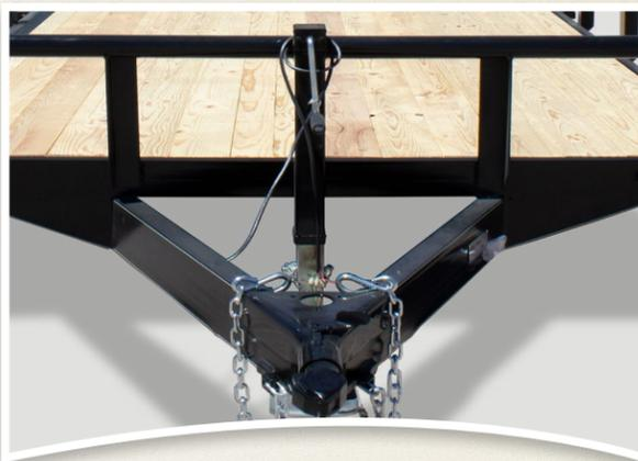
Equipamiento: gato de 7,000 lb, cadenas de 1/4 de pulgada, jalón tipo A, de 7,000 lb, lanza de canal estructural de 6".
