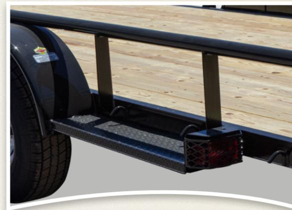
Luces de leds, ganchos para sujeción y atado de las cargas, redilas de 16 pulgadas, reforzados con postes de ángulo.
