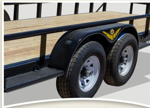
Llantas y rines de 16 pulgadas, estribos en lámina antiderrapante, guardafangos dúplex, tipo gota, piso de madera.
