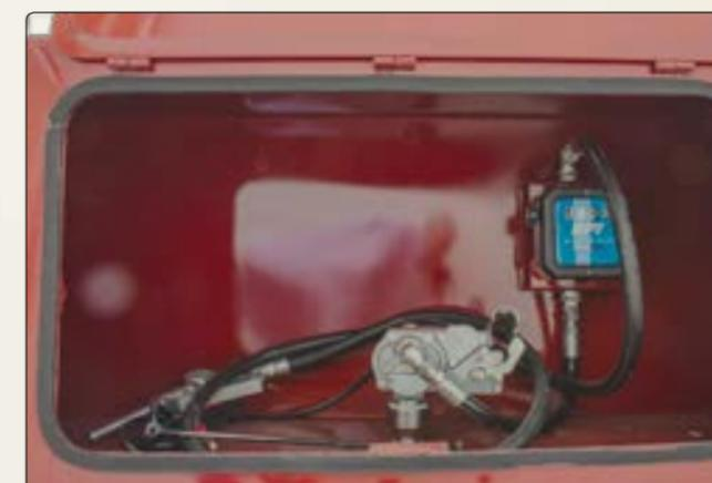
Interior del compartimiento dónde se instaló la bomba de combustible, con pistola dispensadora, gatillo dosificador; así como el marcador digital de litros despachados.
