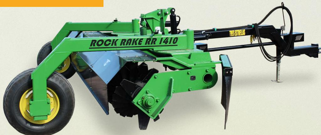
Un equipo de avanzada tecnología para acondicionar los terrenos de cultivo, particularmente para el despiedre mecanizado, cuenta con un cilindro que tiene dispuestos dientes, en un arreglo con dos filas en espiral, de forma que su rotación permite que ingresen los dientes en la superficie del suelo, dicha rotación le proporciona un giro helicoidal, que atrapa con el cilindro las rocas, desplazando éstas hacia el costado izquierdo concentrando los sólidos en ese lado.
