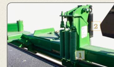
El sistema de suspensión, ayuda a que el cilindro se adapte al contorno del terreno. Resortes (1) y gato (2).
