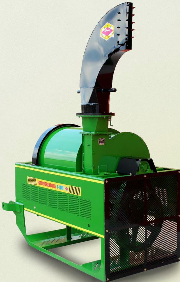
La espolvoreadora F-100 es un equipo para tecnificar la aplicación de fertilizantes, insecticidas, bactericidas, fungicidas, sustancias reguladoras de crecimiento, defoliantes, herbicidas y nutrientes de suelos, cuando la presentación de éstos sea en polvo o granulados secos.
