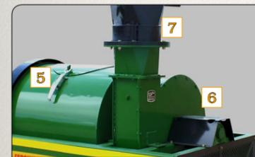
Tapa y cerradura del tanque (5), porta abanico (6), tubo esparcidor (7).
