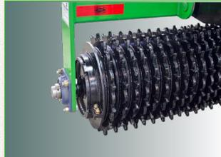
Detalle del rodillo donde se aprecian los discos con picas, así como el ajuste de éste al chasis.
