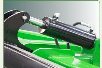
El cilindro funciona mediante el hidráulico del tractor, controla la presión del rodillo sobre la superficie.
