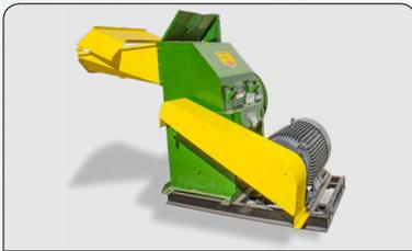
*Vista lateral, se destacan las guardas de protección de las bandas.*
