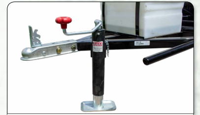
Detalle del gato de sustentación y jalón.
