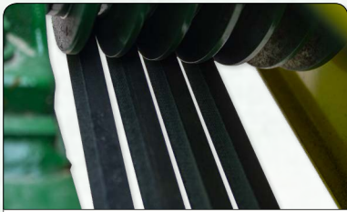
Polea conducida, ranurada, con 4 bandas trapezoidales (tipo V).
