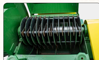
Cilindro de trituración de martillos sueltos.
