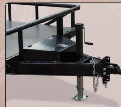
Jalón de 12,500 mil libras, de fundición, gato con palanca en la parte lateral-superior, de 7 mil libras, cadenas de seguridad.
