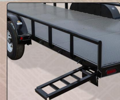
Piso de lámina antiderrapante, rampas tipo escalera de ángulo, resguardadas en un receptáculo para ese uso específico.
