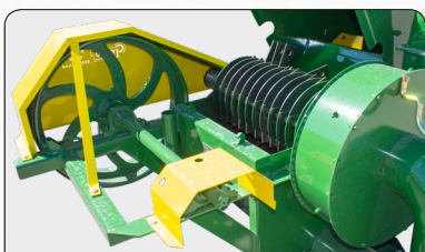
Vista de la polea y flecha motriz, cilindro, así como la conexión a PTO.
