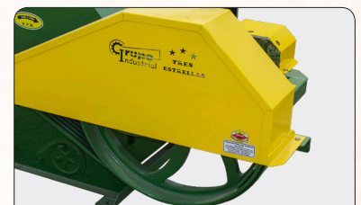
Guardas de protección de poleas y bandas, seguridad ante todo.
