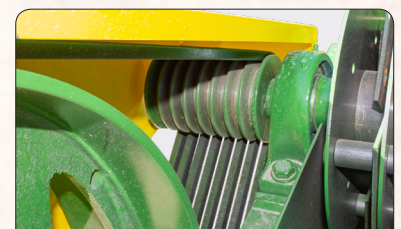
Polea conducida y las ocho bandas trapezoidales.
