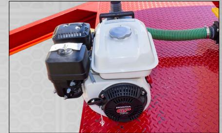
En las imágenes se observa el sistema que permite expulsar de forma eficiente los líquidos que pueda contener el tanque, éste incluye un motor a gasolina de cuatro cilindros marca Honda modelo GP 160, cuyas especificaciones se listan en el gráfico de abajo, con centrifuga y conexiones de 2 pulgadas.
