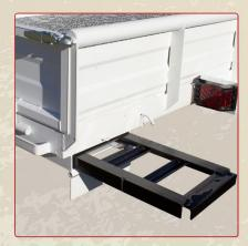
En la imagen: en la parte inferior del remolque se resguardan las rampas tipo escalera, una a cada lado.
