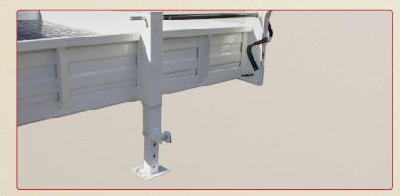
En este gráfico se puede observar el gato de elevación con palanca en la parte lateral, capacidad de 10,000 libras, el tubo para levantar-bajarlo, fijo en la parte delantera del equipo, así como las redilas de 12 pulgadas de altura.
