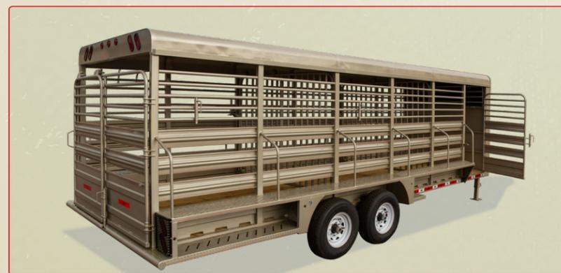
Perspectiva lateral-posterior, se observan los detalles de las redilas, los estribos, los rines y llantas de 8 tuercas, de 16 pulgadas, las seis asideras, así como los postes-vigas en "U" invertida.
