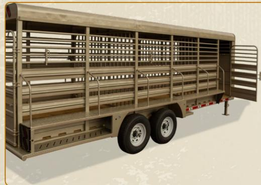
Puerta trasera de dos hojas, con redilas metálicas tipo duela y travesaños tubulares, una de las hojas abre de forma corrediza, sobre dos carretillas de cylamid. Con dos puertas intermedias, tubulares, pueden separar el área de carga en 1, 2 o 3 áreas independientes, abren de la misma forma que la trasera. Tiene una puerta de escape, con duela metálica y travesaños tubulares, en la parte lateral delantera derecha.
