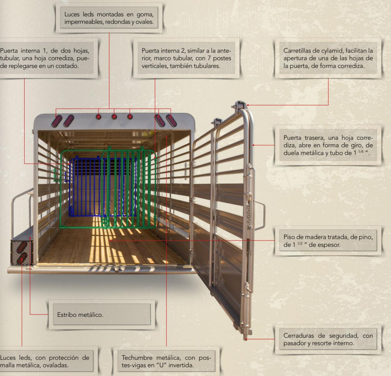
Luces leds montadas en goma, impermeables, redondas y ovales.
