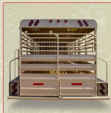
En la imagen: distribución de las luces leds; la puerta posterior de dos hojas, fabricada con un marco tubular, tres secciones de duela metálica y travesaños de tubo.
