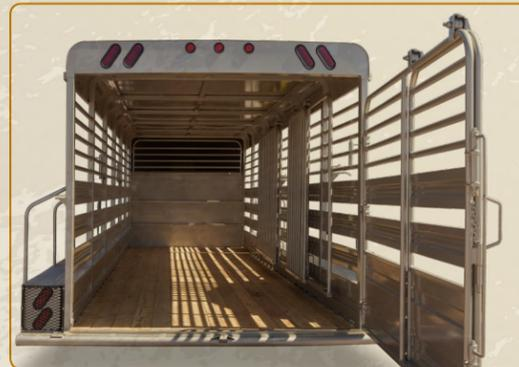
Techumbre metálica que recubre la totalidad de la zona de carga, con un domo de fibra de vidrio en la parte frontal. Piso de madera de pino, tratada, de 1.5 pulgadas de espesor. Al fondo, un pequeño espacio con puerta tubular, para resguardar artículos y aperos relativos a la actividad ganadera.
