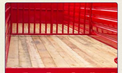
La plataforma de carga está recubierta por madera de 1.5 pulgadas, cuenta con una puerta intermedia que separa el área de carga en dos espacios.
