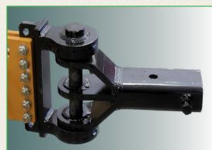
Detalle de la solidez del jalón, con tres puntos de agarre, así como atornillado de seguridad.
