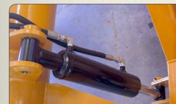
Detalles de uno de los dos cilindros hidráulicos delanteros.
