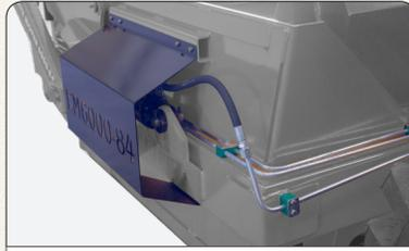
*Uno de los dos cilindros ubicados en la parte lateral del nivelador, debidamente protegido con una coraza.*
