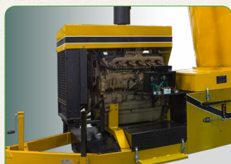
Motor de 6 cilindros en línea, de 6.8 litros.
