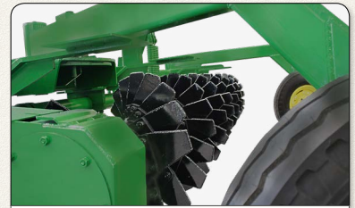
Vista del cilindro con los dientes reforzados en espiral, este arreglo permite desplazar las piedras lateralmente.
