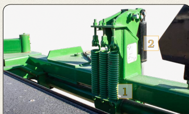
El sistema de suspensión, ayuda a que el cilindro se adapte al contorno del terreno. Resortes (1) y gato (2).
