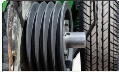
Polea motriz ranurada para 4 bandas trapezoidales (tipo V).
