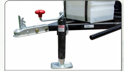
Detalle del gato de sustentación y del jalón.
