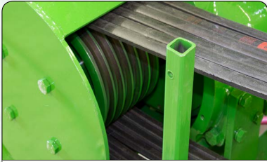
Polea conducida, ranurada para 4 bandas trapezoidales (tipo V).
